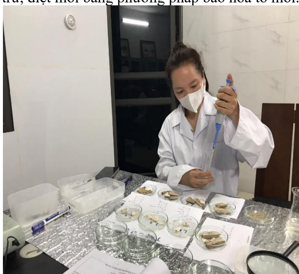
Hình 2. Hình ảnh thực hiện thí nghiệm diệt mối bằng phương pháp phun trực tiếp
