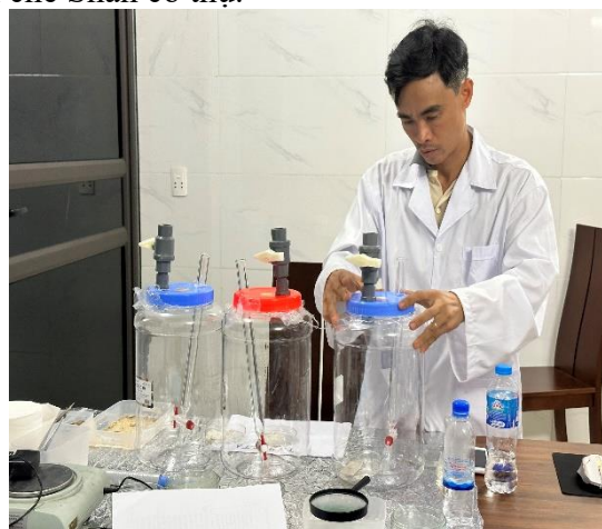
Hình 3. Hình ảnh thực hiện thí nghiệm diệt mối bằng phương pháp xông hơi
